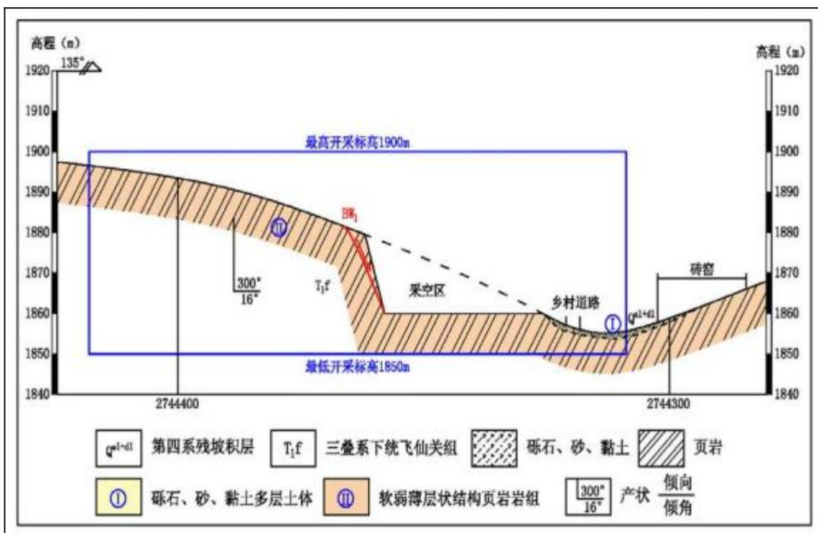
图3-1 BW<sub>1</sub>不稳边坡剖面示意图
