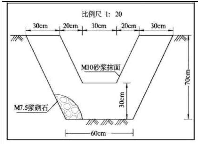
图5-1 露天采场底部排水沟剖面示意图
